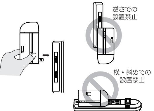
※取り付け・取り外し時は、本体下部のくぼみを持ち、真っ直ぐに抜き差ししてください。
